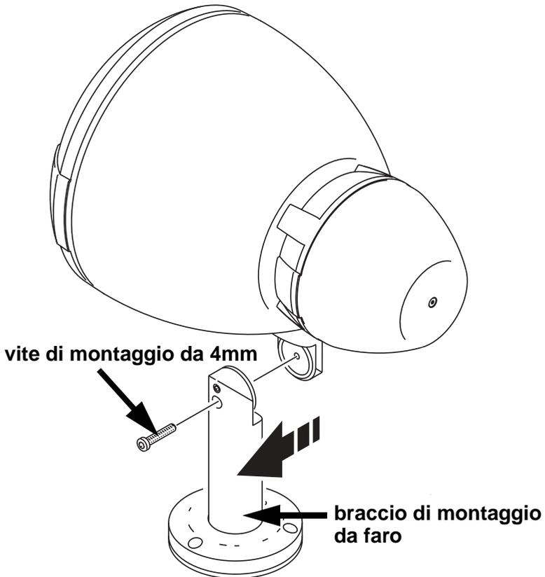
montaggio da 4mm. Conservare la vite a brugola di montaggio da 4mm per poterla riutilizzare con il braccio di montaggio Alien 02.
