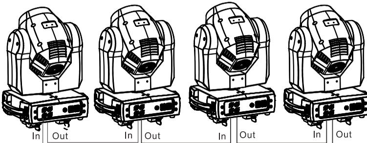
Die Zahl der Geräte in einer Datenlinie ist durch die Zahl der Kanäle, die jedes Gerät belegt, begrenzt. Eine DMX Datenlinie stellt 512 DMX Kanäle zur Verfügung. Für die unabhängige Steuerung der Geräte einer Linie muss jedem Gerät ein eigener Adressbereich zugewiesen werden. Geräten, die sich identisch bewegen sollen, kann der selber Adressbereich zugewiesen werden. Wenn Sie mehr Geräte oder Gerätegruppen unabhängig steuern wollen, benötigen Sie zusätzliche DMX-Linien.
