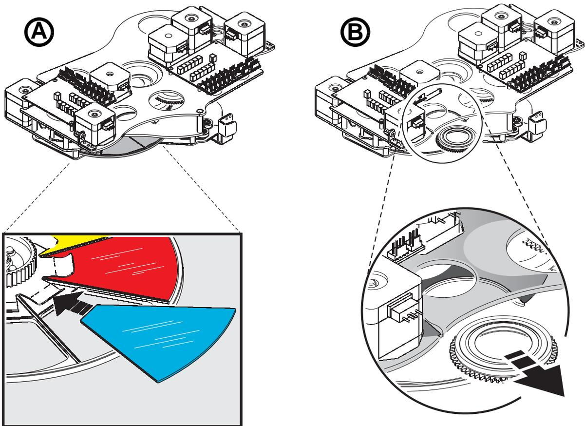
**Figure 21: Remplacement des couleurs et des gobos**
