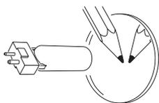
Pour limiter le risque de surchauffe et de dégâts, tournez la face la plus réfléchissante vers la lampe.
