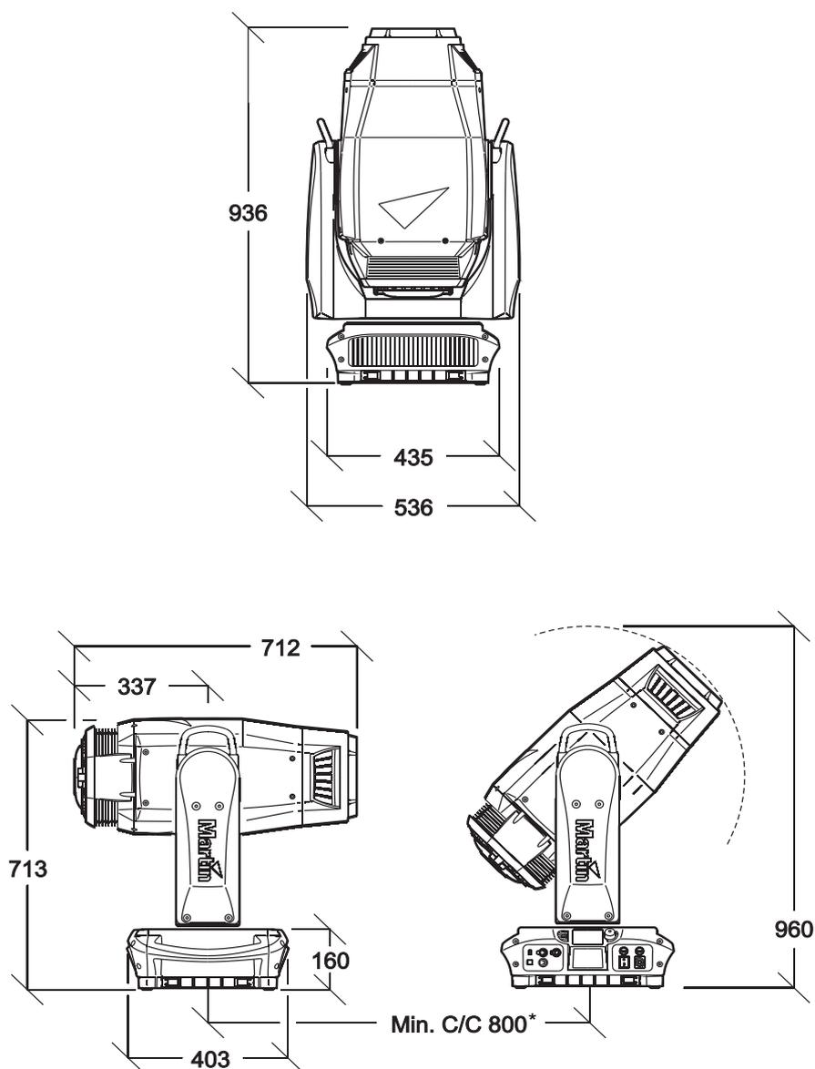
*\*La distance minimale centre-centre peut être réduite en limitant l'amplitude de pan dans les menus*
