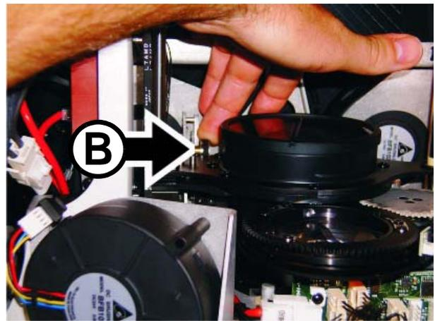
Figure 27: Avancer manuellement le chariot Zoom / Mise au point
