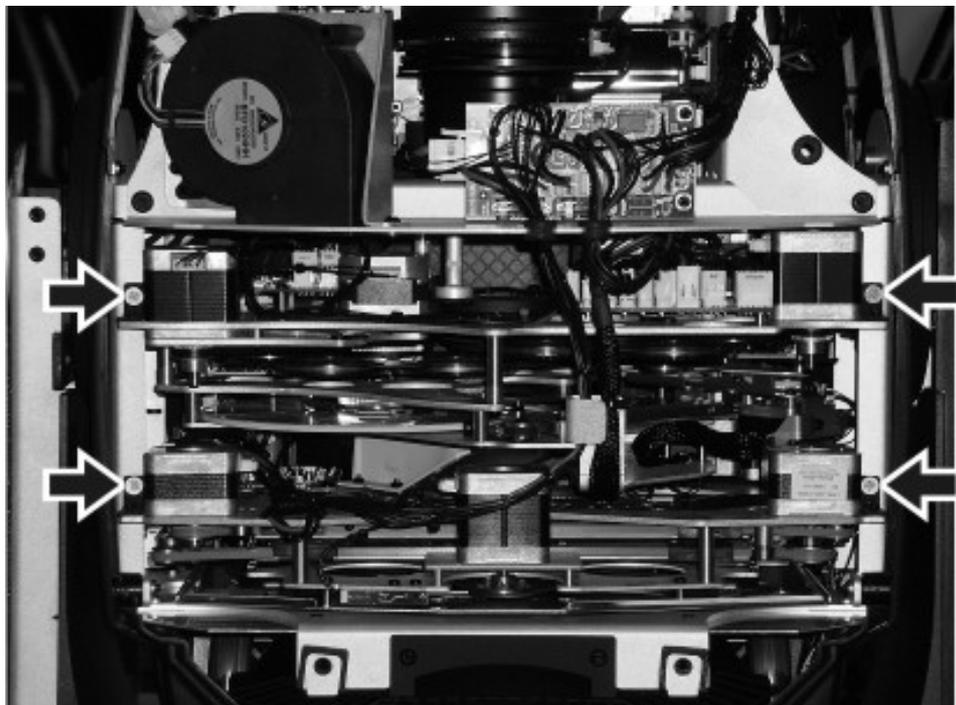
Figure 28: Vis de fixation des modules
