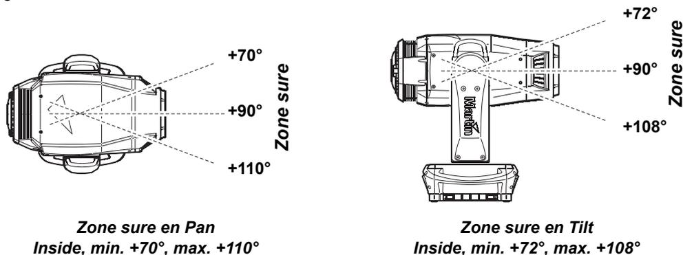
Figure 10: Réglage des limites de pan et tilt
