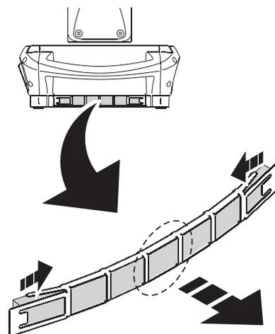
Figure 18: Filtres à air de la base
