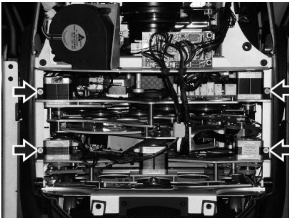
Bild 27: Befestigungsschrauben der Module
