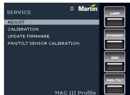
**¡Atención!** Tan pronto abandone la calibración del sensor de pan/tilt, la cabeza retornará a su posición original.
