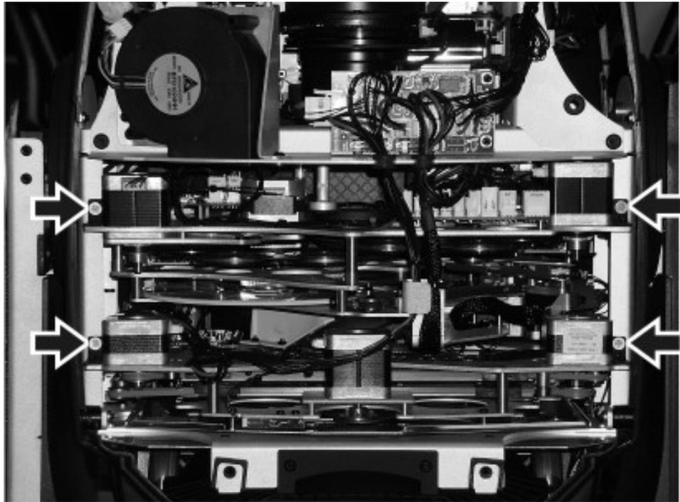
**Figura 26: Tornillos de fijación del módulo**
