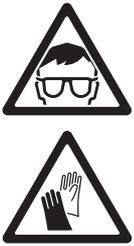
**¡Atención!** *Cuando se manipulen lámparas de descarga, utilizar gafas de seguridad y guantes. El bulbo transparente está integrado en la base cerámica. No tratar de separar el bulbo de la base.*
