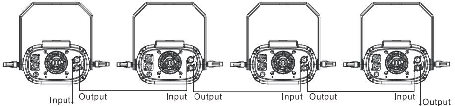
Die Zahl der Geräte in einer Datenlinie ist durch die Zahl der Kanäle, die jedes Gerät belegt, begrenzt. Eine DMX Datenlinie stellt 512 DMX Kanäle zur Verfügung. Für die unabhängige Steuerung der Geräte einer Linie muss jedem Gerät ein eigener Adressbereich zugewiesen werden. Geräten, die sich identisch bewegen sollen, kann der selber Adressbereich zugewiesen werden. Wenn Sie mehr Geräte oder Gerätegruppen unabhängig steuern wollen, benötigen Sie zusätzliche DMX-Linien.
