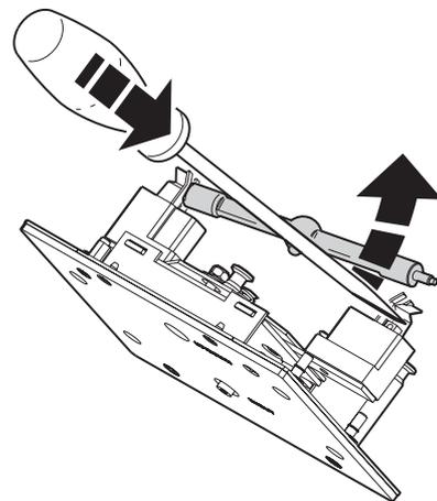
Figura 1: Extracción de lámpara
