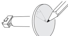
La cara menos reflectiva del gobo recubierto absorberá menos temperatura si se orienta lejos de la lámpara.
