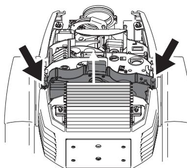
**Figura 20: Palancas de bloqueo del módulo CMY**
