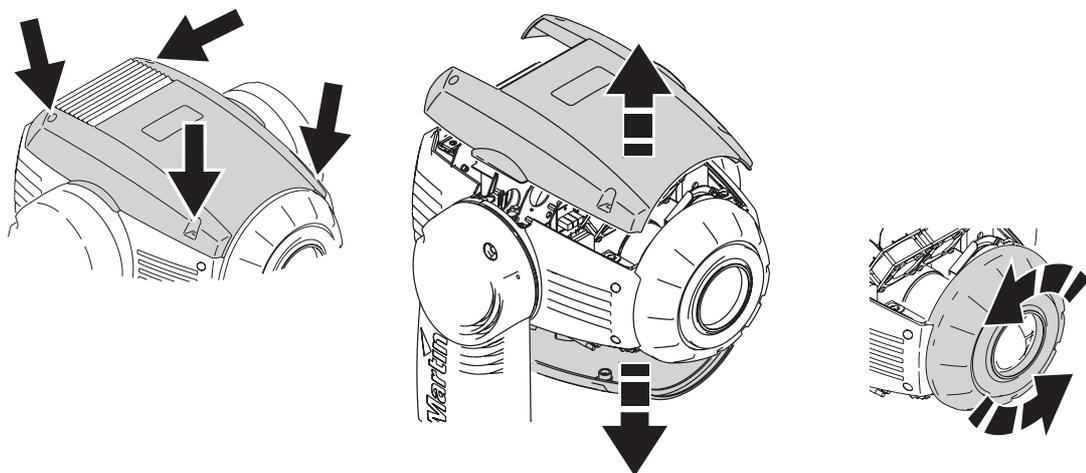
Figura 15: Extraer la cubiertas superior e inferior y la lente frontal
