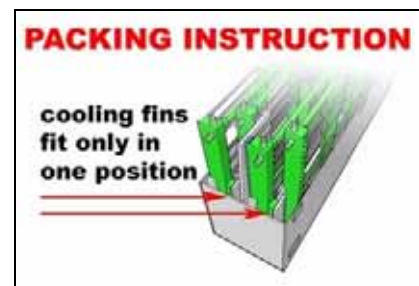
Bild 2: Anordnung der Module im Flightcase
