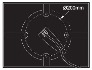
Le bras de déport peut être fixé en utilisant 4 vis M10 x 25 et des rondelles caoutchouc (prévention des vibrations)..
