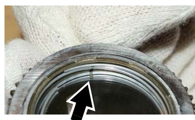
Figure 23: Répères d'alignement des gobos
