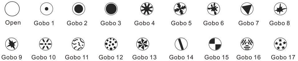
Jedes Gobo kann statisch projiziert werden. Goboteileffekte werden unterstützt. Das Rad kann im oder gegen den Uhrzeigersinn gedreht werden. Die Abbildungsschärfe der Gobos kann mit dem Fokus eingestellt werden.
