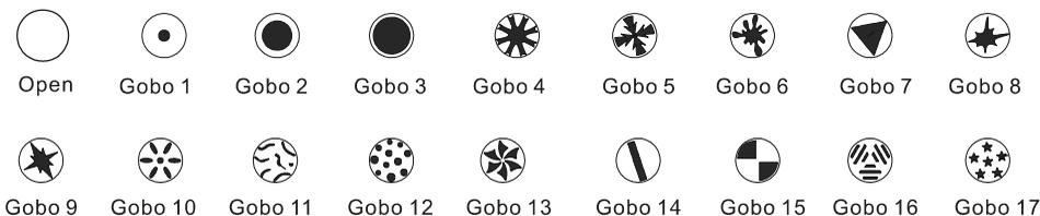
Chaque gobo peut être projeté de manière statique et la roue peut être mise en rotation continue dans le sens horaire ou anti horaire, avec une vitesse réglable. La netteté des gobos est réglable en DMX avec le canal de mise au net.
