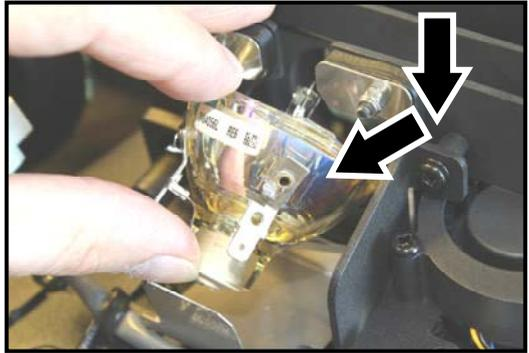
6. Mettez des gants en coton qui ne peluchent pas. Placez la lampe contre les ressorts et glissez-la en place en veillant à bien positionner le haut du réflecteur. Vérifiez que la nouvelle lampe est maintenue correctement dans la même position que l'ancienne lampe et qu'elle est à peu près centrée sur l'ouverture à l'avant du support.
