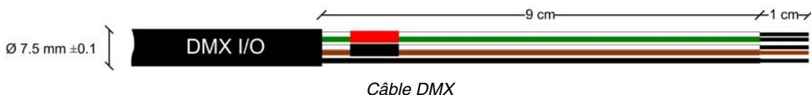
Le raccordement peut être réalisé directement dans une boîte de dérivation étanche ou avec des connecteurs XLR étanches. Protégez les connecteurs dans une boîte de dérivation étanche si leur indice de protection n'est pas suffisant.
