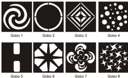
Para evitar pasar la posición abierta al cambiar los colores y los gobos, use el comando DMX del canal 10 "Parameter shortcuts = OFF" (Acceso directo a parámetros = Apagado). Para realizar cambios de color y gobo más rápidos, use "Parameter shortcuts = ON" (Acceso directo a parámetros = Encendido).
