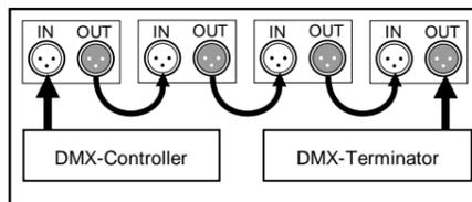
Die Buchse DMX IN dient zum Anschluss eines DMX-512-Controllers. Die Buchse DMX OUT lässt sich zum Anschluss von bis zu 32 Geräten insgesamt in einer Daisy Chain nutzen. So wird ein DMX- bzw. synchronisierter Master-Slave-Betrieb möglich.
