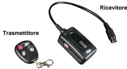
Il ricevitore si collega alla presa del telecomando sulla macchina ed ha una calamita sul retro per l'attacco. Il LED rosso del ricevitore indica che la macchina si sta riscaldando; quando si spegnerà, la macchina sarà pronta per l'uso.
