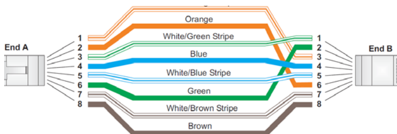
FIG. 25 Crossover Wiring
