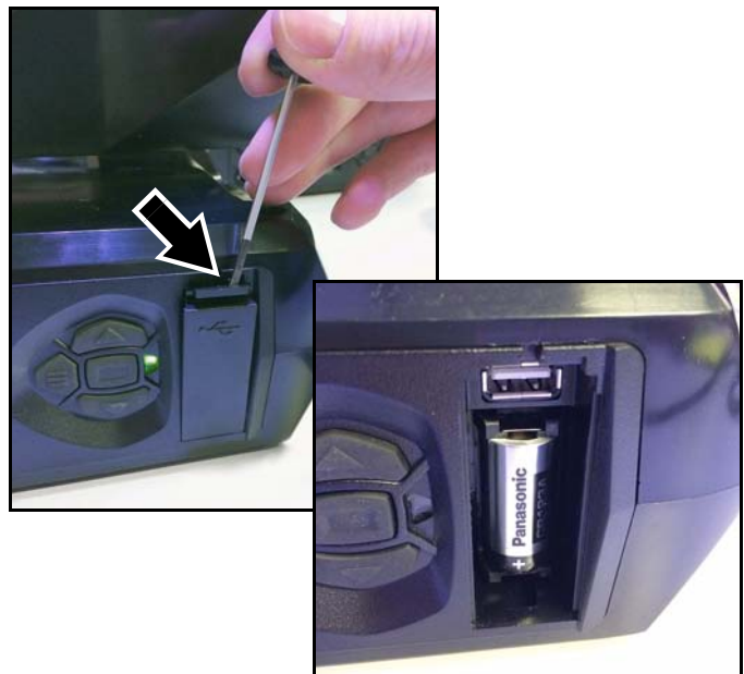
Figure 17: Compartiment de batterie
