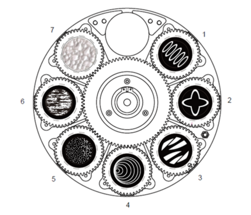
Roue de gobo 1 (gobos rotatifs/indexables)
