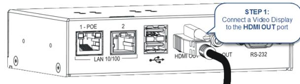
FIG. 6 VIDEO OUTPUT CONNECTION
