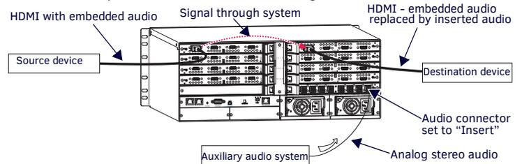
**FIG. 3** AUDIO INSERTED ONTO HDMI OUTPUT SIGNAL
