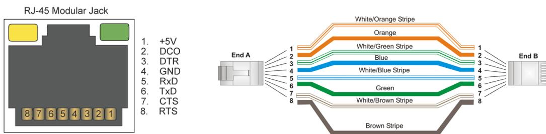
**FIG. 13** RJ-45 Receptacle Pin-out
